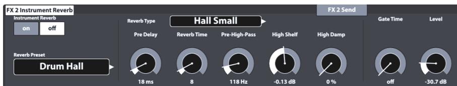
Ce module dispose d'algorithmes classiques et génériques pour la simulation de la réverbération spécifique d'un instrument. Certains **Types de réverbération** sont générés électroniquement de manière traditionnelle, alors que d'autres types (par exemple, Plaque (Plate)) imitent des dispositifs mécaniques conçus pour ajouter une réverbération artificielle à l'enregistrement non traité (Dry).
