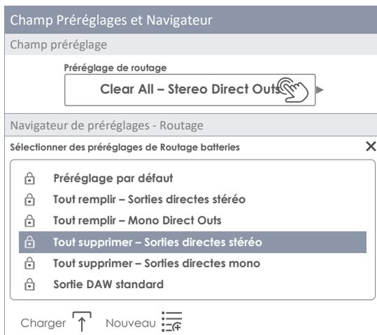
La palette des préréglages disponibles pour l'utilisateur est plus vaste, car les préréglages d'usine ne peuvent pas être modifiés. Pour comparer les préréglages, appuyez sur un préréglage utilisateur et sur un préréglage d'usine dans la boîte de dialogue Sélectionner préréglage. Consultez le tableau suivant comme référence.
