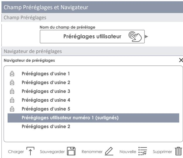
La palette des préréglages disponibles pour l'utilisateur est plus vaste, car les préréglages d'usine ne peuvent pas être modifiés. Pour comparer les préréglages, appuyez sur un préréglage utilisateur et sur un préréglage d'usine dans la boîte de dialogue Sélectionner préréglage. Consultez le tableau suivant comme référence.
