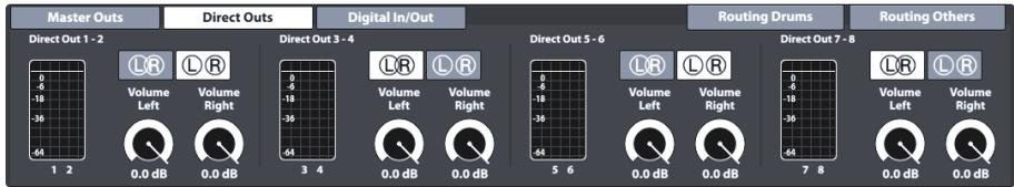
Les réglages des **Sorties directes** fonctionnent de manière similaire aux **Sorties principales**, sauf que les **Sorties directes** peuvent être configurées comme des sorties **Dual Mono** ou des sorties Stéréo. Le choix de la configuration prendra effet dans la matrice de routage **Routage batteries** (*Consultez la section 12.1.4 Routage Batteries et Routage Autres (Routing Drums & Routing Others) à la page 112*).
