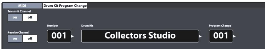
Cet ensemble de fonctions détermine les règles pour les modifications du logiciel MIDI. Comme la Batterie G9 est un dispositif rythmique, elle est compatible avec le protocole MIDI standard. Les logiciels qui peuvent être modifiés correspondent à des batteries disponibles dans le **Navigateur de batteries (Drum Kit Browser)**, où le **numéro d'index de la batterie est égal à celui du logiciel**.
